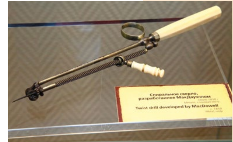
Спиральное сверло, разработанное МакДауэллом
