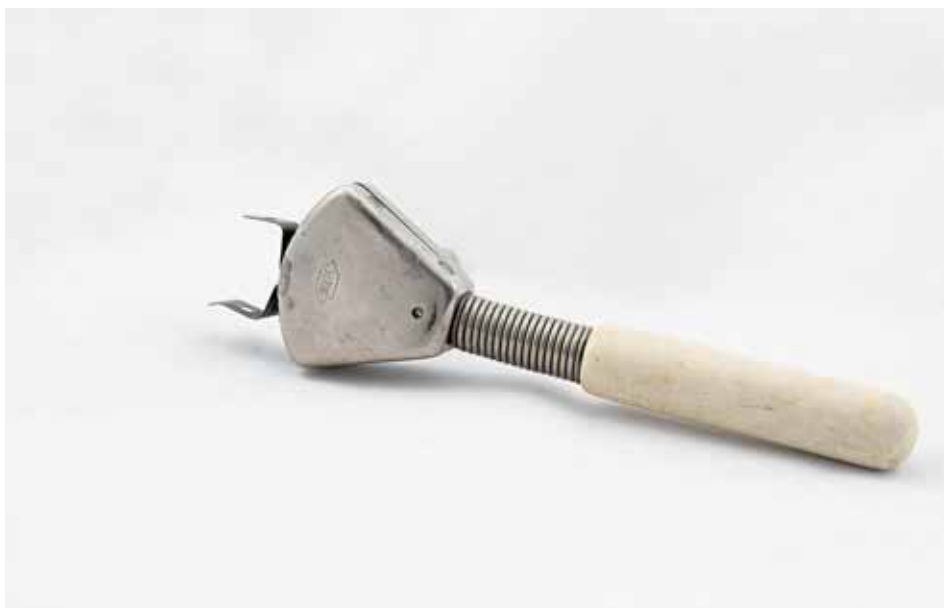
Насадка на бормашину для замешивания амальгамы, США, середина XX века. Металл, пластик
