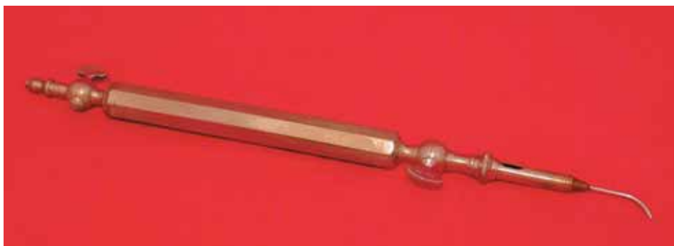
Инструмент для моделирования воска. Использовался при изготовлении зубных протезов, конец XIX века. Металл
