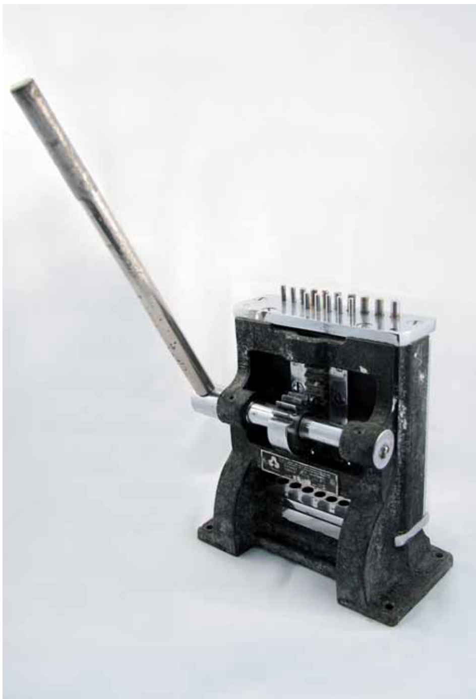
«Самсон» – прибор для протяжки гильз, используется при изготовлении зубных протезов, середина XX века. Металл
