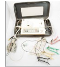
Аппарат для снятия электрокардиограммы. СССР, вторая половина XX в. Металл, полимерный материал, резина
